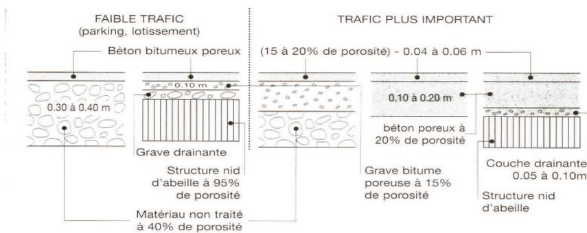
Préparation de la structure-réservoir
