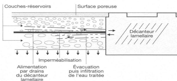
Face au risque de pollution accidentelle, des dispositifs d'épuration et de prétraitement doivent être installés. Par exemple, une géomembrane permet d'isoler la structure réservoir du sol : une série de drains collecte les eaux en fond de réservoir et les conduit vers des décanteurs, une autre série part de ces décanteurs pour amener l'eau sous la géomembrane, à débit régulé, afin qu'elle s'infiltré dans le sol.
