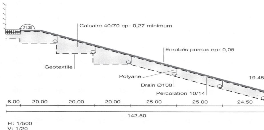
Pour augmenter la capacité de stockage dans le matériau poreux, on pourra mettre en œuvre une chaussée à structure réservoir en cascade à l'aide de cloisons et de surépaisseur.
