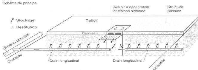
Fonctionnement des drains en charge et en décharge.
