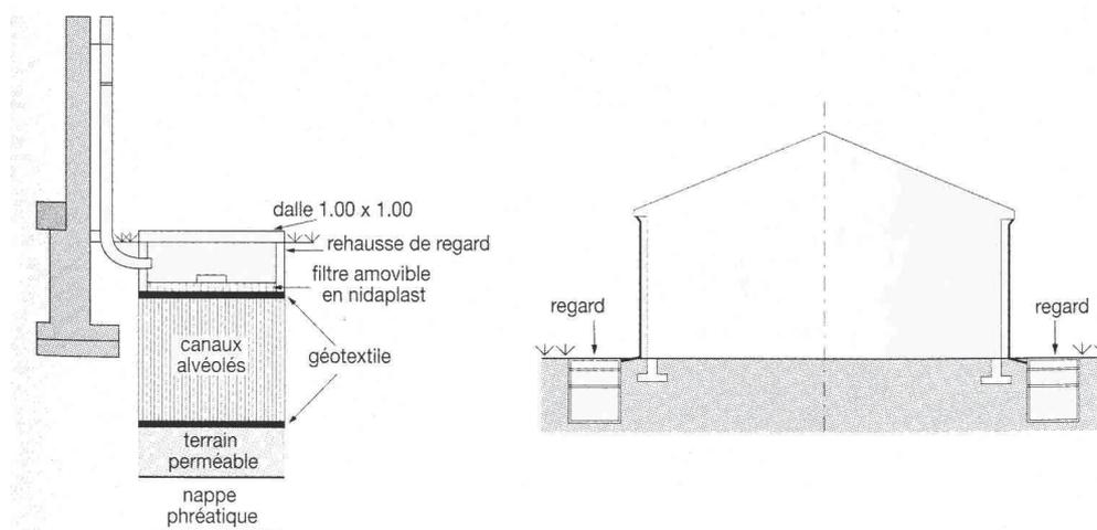
Exemple de puits d'infiltration de la Communauté Urbaine de BORDEAUX (CUB)
