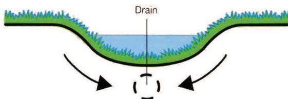
**Drain placé sous une noue**
