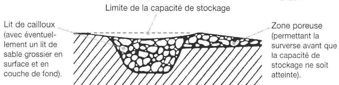
*Puits d'infiltration disposé dans le lit d'un fossé.
